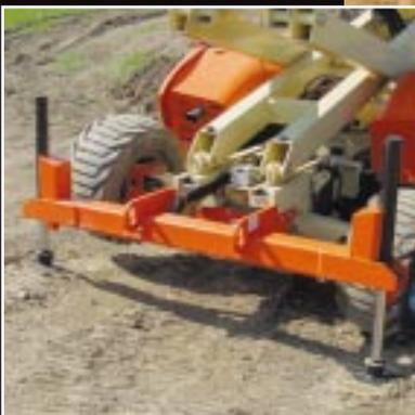
*Soportes de nivelación óptima One-Touch para un montaje más rápido*
